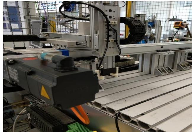
Die Station 4 wurde mit einem Frequenzumrichter von Siemens modifiziert.
